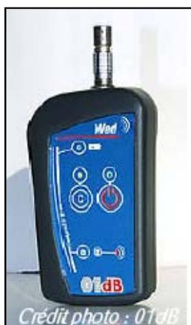
*Le dosimètre exposimètre Wed007, technologie 01dB*
