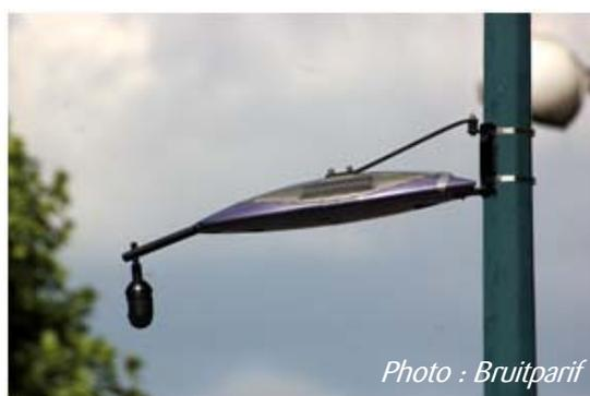
*Station de mesure autonome en énergie de technologie Azimut Monitoring*
